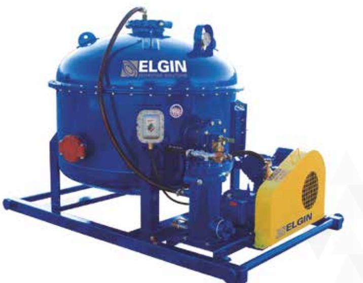
La degasificadora al vacío es la forma más común de degasificar sistemas utilizada en la industria de oil & gas. El fluido de perforación es llevado hacia el tanque por la acción del vacío. El fluido asciende dentro del tanque y es distribuido por una serie de láminas que liberan las burbujas de gas del fluido de perforación. El gas es bombeado fuera del sistema y el fluido es transferido a los hidrociclones o la centrifugadora para el procesamiento ulterior.
