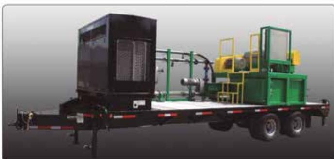
Utilizando un tráiler de triple eje de 30 K, la pulidora XP ESS-1448HD2 se integra con los recursos de control de sólidos existentes (Tango 400, Tango 600, Tango 800, etc.). Están incorporados los sistemas de energía e inyección química (Select Floc LP3) para la remoción en un 100% de los sólidos suspendidos.
