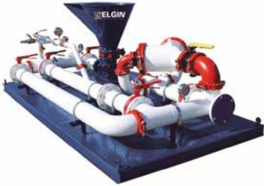
Gracias a nuestra historia única como proveedores de químicos de alto rendimiento, hemos desarrollado una línea de sistemas de cizallas para los fluidos de perforación. Los sistemas de cizallas están diseñados para utilizar el cizallamiento hidráulico que permite mezclar eficientemente los sólidos con los líquidos.
