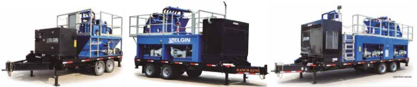
Estas máquinas están diseñadas para contratistas de la industria de perforación con plataformas Maxi-Class sin zanjas, con pozos de agua, geotérmicas, de perforación de cimientos y de micro-túneles.
