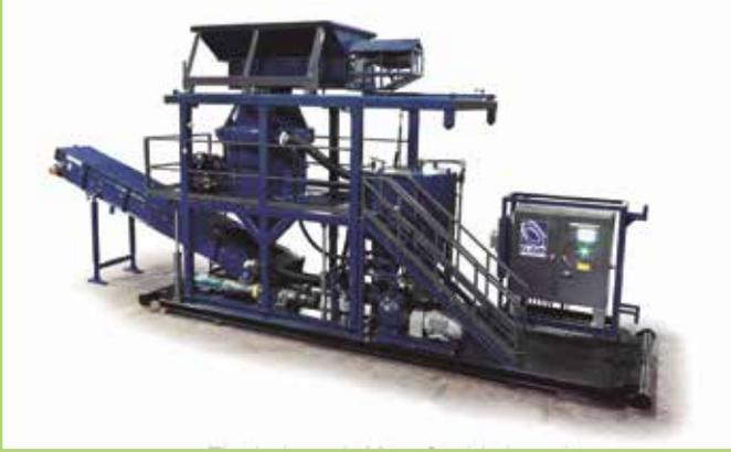
El sistema de gestión de residuos de cuttings CSI-D4TM, totalmente integrado y listo para ser usado, es el sistema disponible de gestión de residuos sólidos más sofisticado de la industria. Este sistema ha sido diseñado para reducir la humedad en los cuttings de perforación y residuos sólidos en >90%. Esto permite a los operadores recuperar varios metros cúbicos de fluidos de la perforación y/o agua que normalmente hubieran sido eliminados con los residuos de cuttings.
