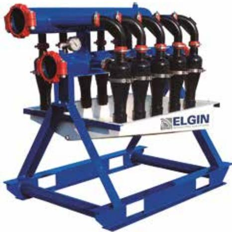
Los hidrociclones moldeados en poliuretano están disponibles en una variedad de configuraciones, desde los sistemas de 60 gpm hasta los sistemas de 2.000 gpm, y son capaces de alcanzar un punto de corte de sólidos de 25 micrones.
