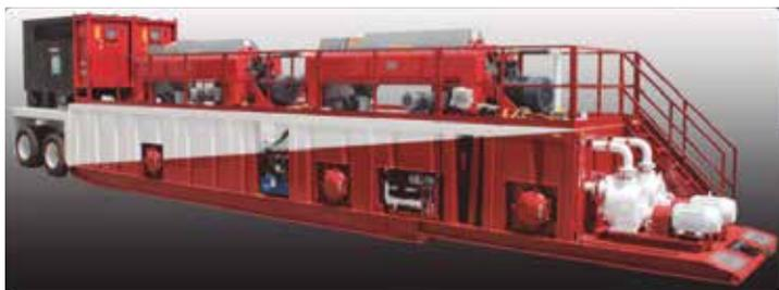
Montados en un triple eje de 36 K cuando se usa una única centrifugadora ESS-1967HD2, o en un tráiler de doble eje de 56' cuando se usan dos centrifugadoras ESS-1967HD2, estos sistemas están diseñados para manejar grandes volúmenes de fluidos de perforación sin reducir la velocidad de las operaciones de perforación.
